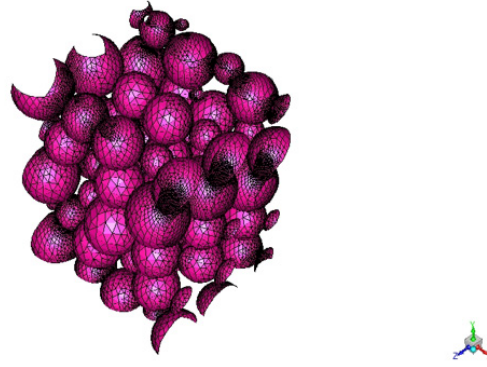
Şekil 8. Geçirimli ortam olarak kullanılacak geometrinin ağ örgüsü
